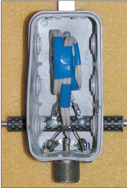
Bild 7: Dose der 12,5-Ω-Yagi mit 2 x 50-Ω-Teflon-Kabel
