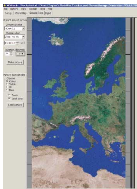
Bild 2: Um zu sehen, ob der ausgewählte Satellit bei seinem Überflug auch den erhofften Ausschnitt aufnehmen kann, ist in WXTrack anhand der eingegebenen Standort- und der Kepler-Daten eine Kartenansicht erstellbar.
