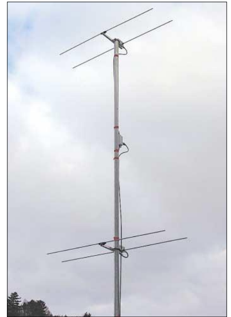
Bild 3: Die Zweiergruppe aus 2 x 28-Ω-Yagis mit Direktor
