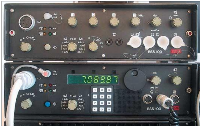
Bild 2: Nach der Modifikation befinden sich rechts oben am Display der Fototransistor und daneben der Drehgeber.
