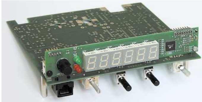
Bild 4: Die Digitalplatine mit den sechs Anzeigen steht senkrecht auf der Analogplatine, die kopfüber in das Gehäuse eingebaut wird.
