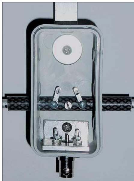
Bild 11: Dose vor Einbau der Transformationsleitungen
