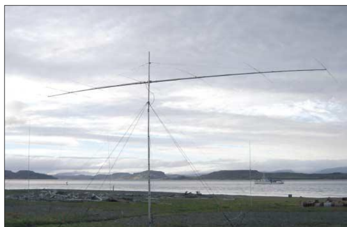
Die 6-m-Langyagi, mit der einige EME-QSOs gelangen. Im Hintergrund weitere Vertikalantennen für Kurzwellen sowie die in der Bucht vor Anker liegende „Braveheart“
