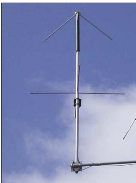
Bild 3: Diese Turnstile-Antenne wurde beim Test verwendet. Durch ihren großen Öffnungswinkel von 180° lassen sich die Satelliten in der Zeit von ihrem Aufgang über Nordafrika, dem direkten Überflug bis hin zum Untergang am Polarkreis ohne Neuausrichtung der Antenne empfangen.
